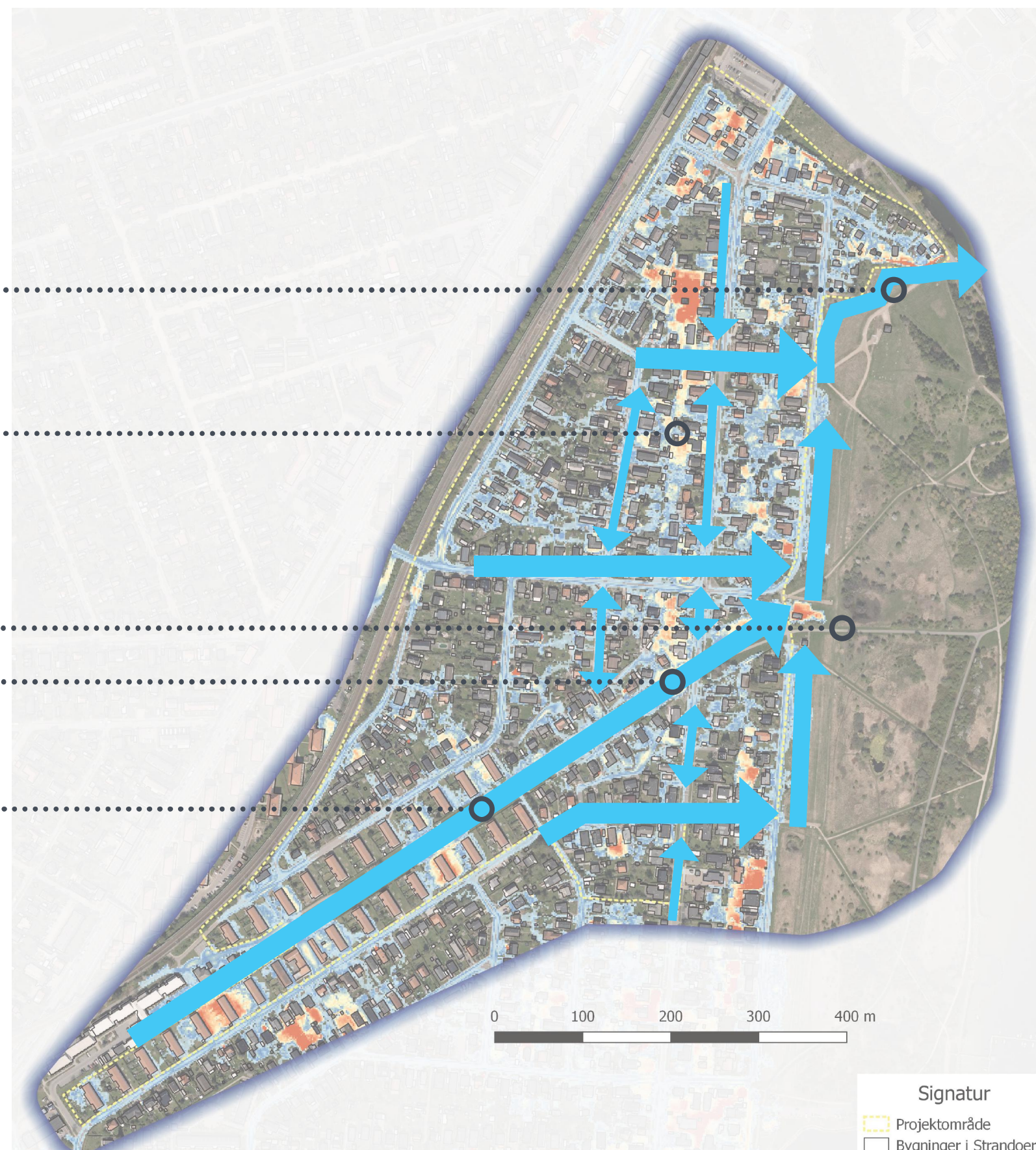
Kort over Strandøre med overordnede strømningsveje til afledning af skybrudsvand
