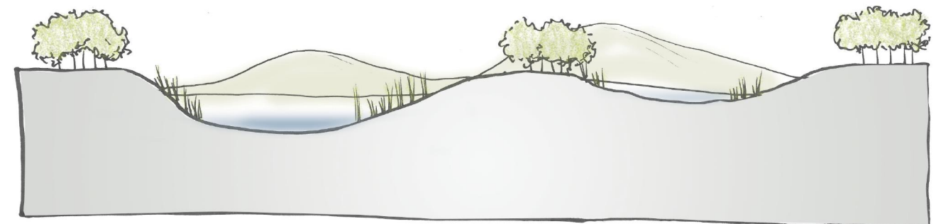
Vand forsinkes og opsamles på strandengen med et større skybrudslandskab. Dynamisk vandspejl og øget biodiversitet.
