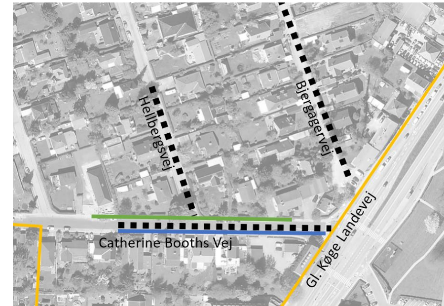
Figur 25 Catherine Booths Vej. Skitse af skybrudsløsning med lokal sænkning af vejen med 20 cm, hvorved vandet kan ophobes på vejen under skybrud. Der anlægges tillige to vejbede.
