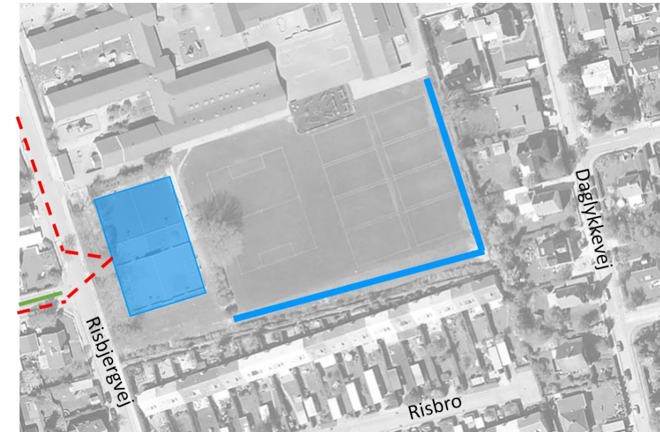
Figur 33 Daglykkevej. Skitse af skybrudsløsning med en rende langs boldbanerne til magasinering af skybrudsvand.
