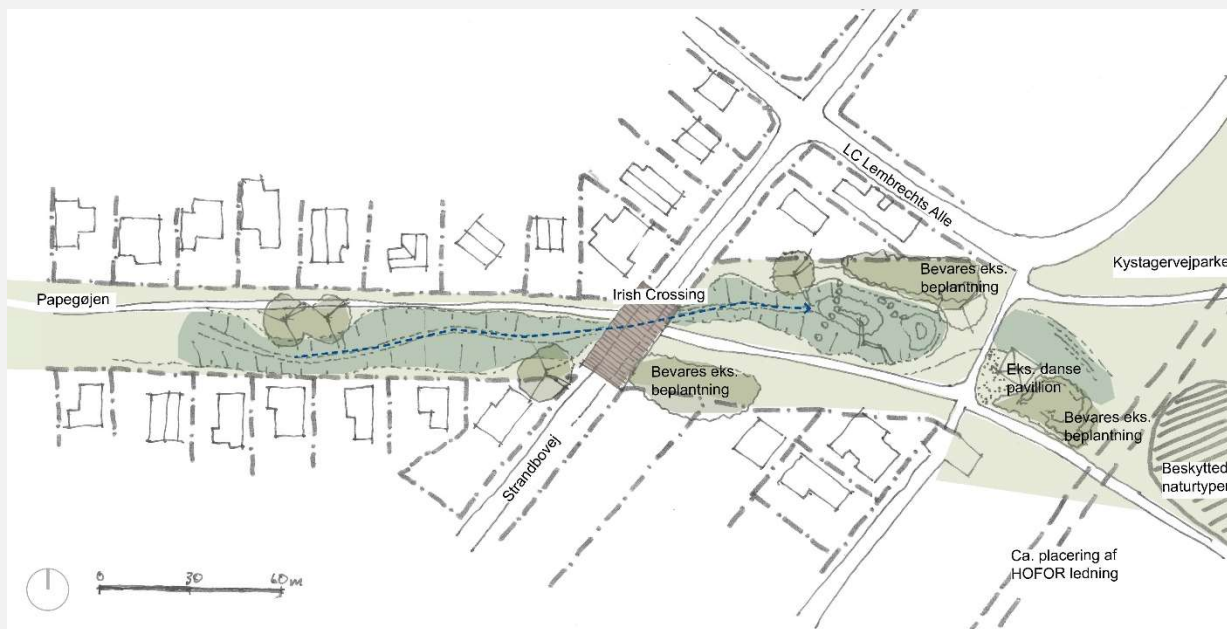
Plan tegning af ID ST 03 Option 2: Afledning mod øst gennem parken og over Strandbovej til magasinering i grønt område. Figuren repræsenterer en overslagsmæssig dimensionering. Kilde: Orbicon.
