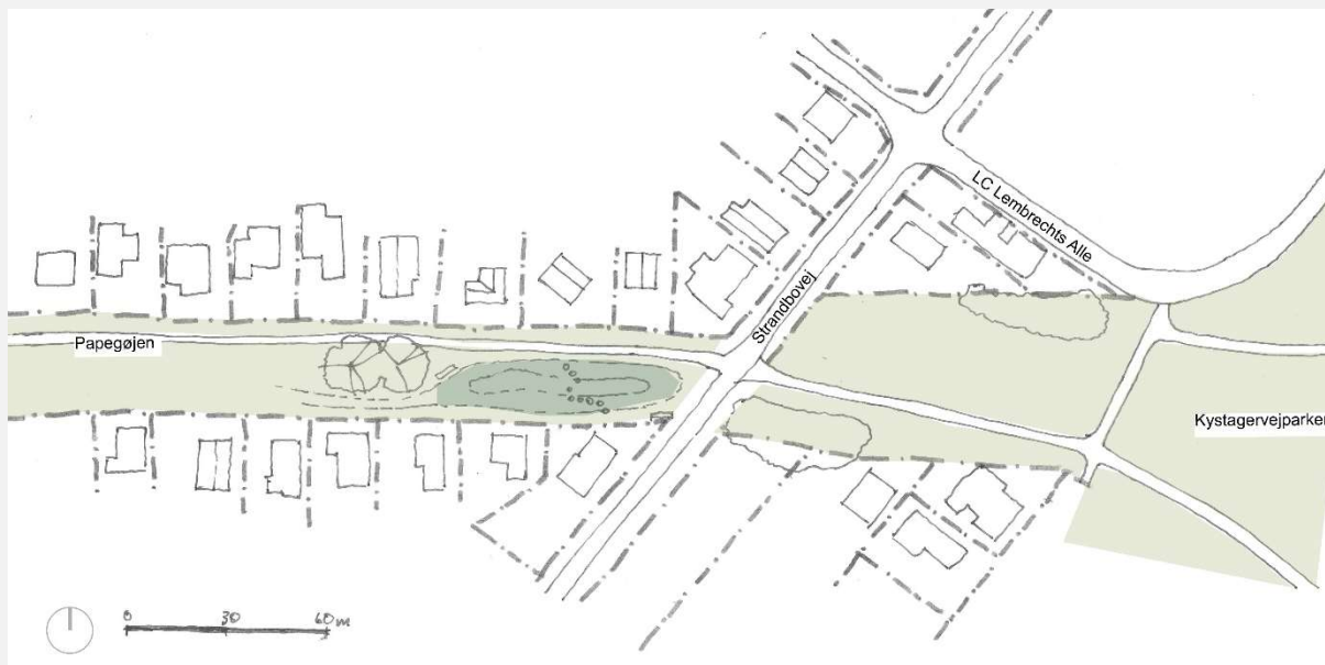
Plan tegning af ID ST 03 Option 1: Lokal magasinering i parken. Figuren repræsenterer en overslagsmæssig dimensionering. Kilde: Orbicon.
