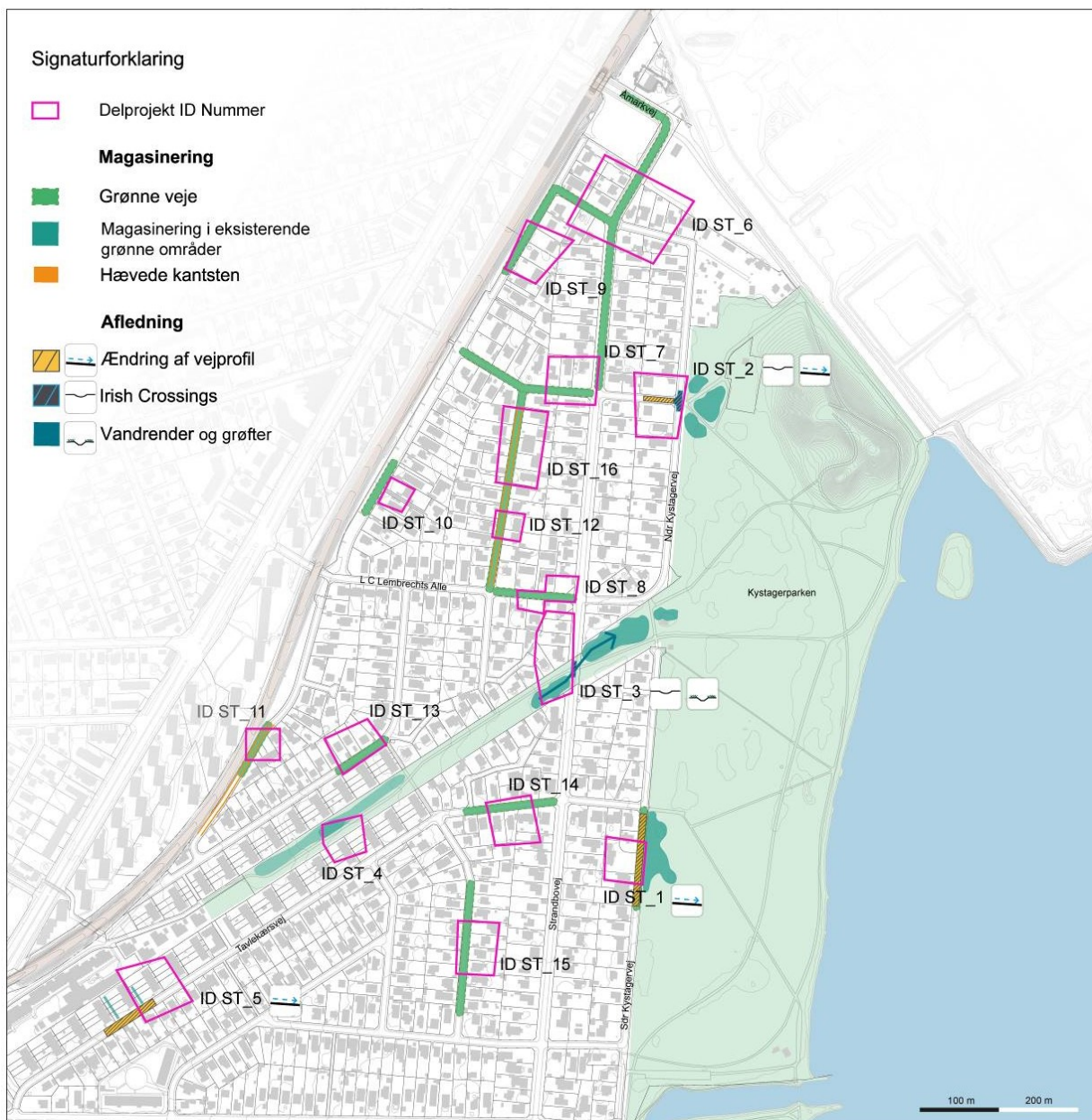
Figur 2: Oversigtskort. Kortet viser indplacering af løsningerne, der er beskrevet nærmere i kapitel 'Gennemgang af delprojekter i Strandøre'. Løsningerne bygger på løsningsprincipperne, som er angivet i signaturforklaringen, og som præsenteres her. Kilde: Orbicon.
